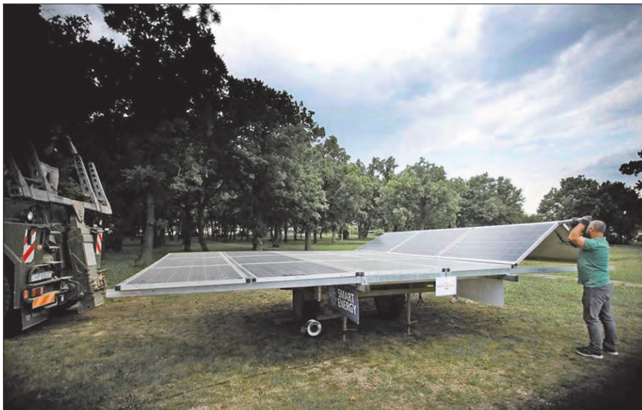
5. ábra. A Multicon-Solar „nehéz” szolár-utánfutója. Nemcsak a méretei nagyobbak, hanem a fedélzetre szerelt akkumulátorok és elektronikus egységek által akár önállóan is képes egy mobil gridet létrehozni
